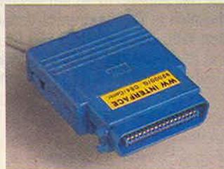
**11** Mit einem Drucker-Interface, hier eines der besten von der Firma Wiesemann, lassen sich nahezu alle Drucker an den C 64 und C 128 anschließen
