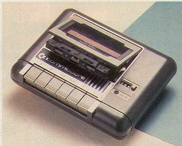
**Bild 2.** Mit Hilfe der preiswerten Datasette lassen sich umfangreiche Datenmengen auf normalen Tonband-Kassetten unterbringen
